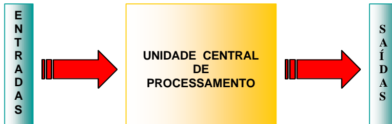
Figura 1 – Estrutura básica de um CLP
